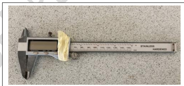
Figure 3 : Pied à coulisse ( Précision 0,01 ).
