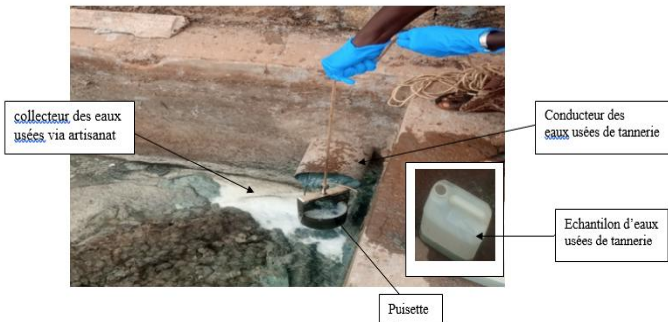
Figure 5 : les étapes de prélèvement des eaux usées de tannerie.
